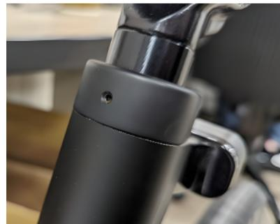
注意：若您的 ebii 20 有安裝雷達，因雷達固定是靠坐桿上束子下壓後止付螺絲的定位。故調整坐墊高低時請勿鬆動雷達止付螺絲，避免雷達晃動。
