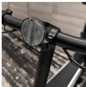
將後反光片與固定座以螺絲鎖緊後，再將固定座安裝鎖緊至坐桿上。
