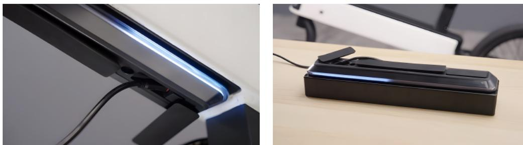
11.1.3 充電時，請您掀開電池蓋板，將充電器插入充電孔中，再將插頭插至100V~240V 電源插座，讓電池充電。
